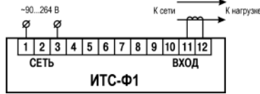
Рисунок 5.3 – Схема подключения с трансформатором
